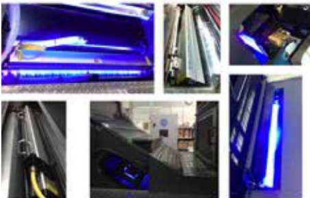
صورة توضح تثبيت وحدات الليد يو في في العديد من ماكينات طباعة الأوفست
